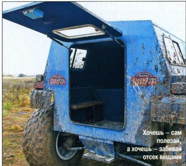
передач оригинальные. Они, во-первых, легче, а во-вторых, позволяют использовать «фордовские» ступицы. Главные передачи мостов, карданы — все находится внутри герметичного несущего кузова. Кстати, в отличие от вездехода Елагина он здесь целиком клепаный. Сомнения в прочности подобной конструкции напрасны — как известно, на заклепках держатся детали фюзеляжей самолетов, и они в воздухе не разваливаются.
